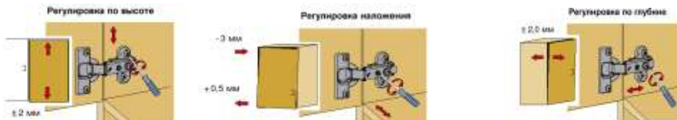
Рис. 3 Схема установки петель
