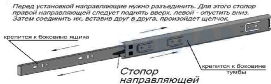
Рис.2 Схема установки шариковых направляющих
