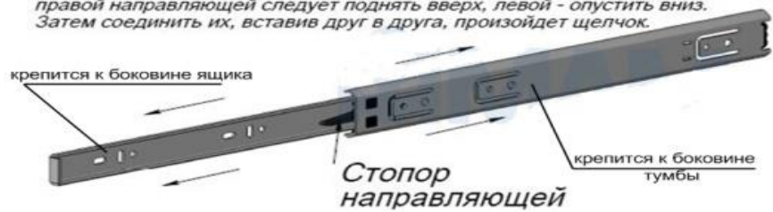
Рис.2 Схема установки шариковых направляющих
