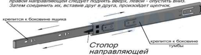
Рис.4 Схема установки направляющих
