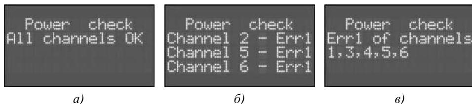
Рисунок 14.6 – Возможные варианты отчётов о втором этапе диагностики в двухблочных котлах, выполненных по схеме звезды: *a* – все каналы исправны; *б* – в каналах 2, 5 и 6 отсутствует ток; *в* – в каналах 1, 3, 4, 5 и 6 отсутствует ток
