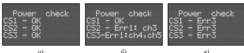
Рисунок 14.8 – Возможные варианты отчётов о втором этапе диагностики в двухблочных котлах, выполненных по схеме треугольник: *a* – все каналы исправны; *б* – в каналах 3, 4 и 5 отсутствует ток; *в* – залипание одного или нескольких реле проверяемых датчиками тока 1, 2 и 3
