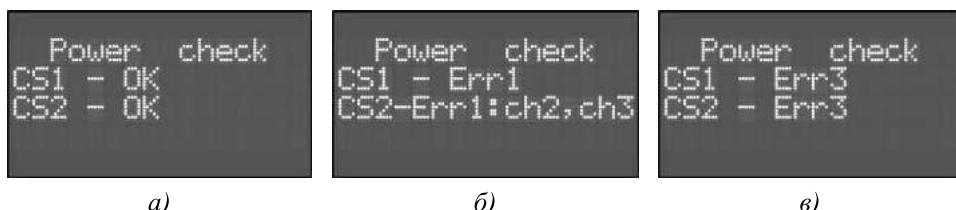
Рисунок 14.7 – Возможные варианты отчётов о втором этапе диагностики в одноблочных котлах, выполненных по схеме треугольник: *a* – все каналы исправны; *б* – в каналах 1, 2 и 3 отсутствует ток; *в* – залипание реле 1 проверяемого ДТ1 (т.к. в данной схеме ДТ1 проверяет только канал 1) и залипание одного или нескольких реле проверяемых ДТ2
