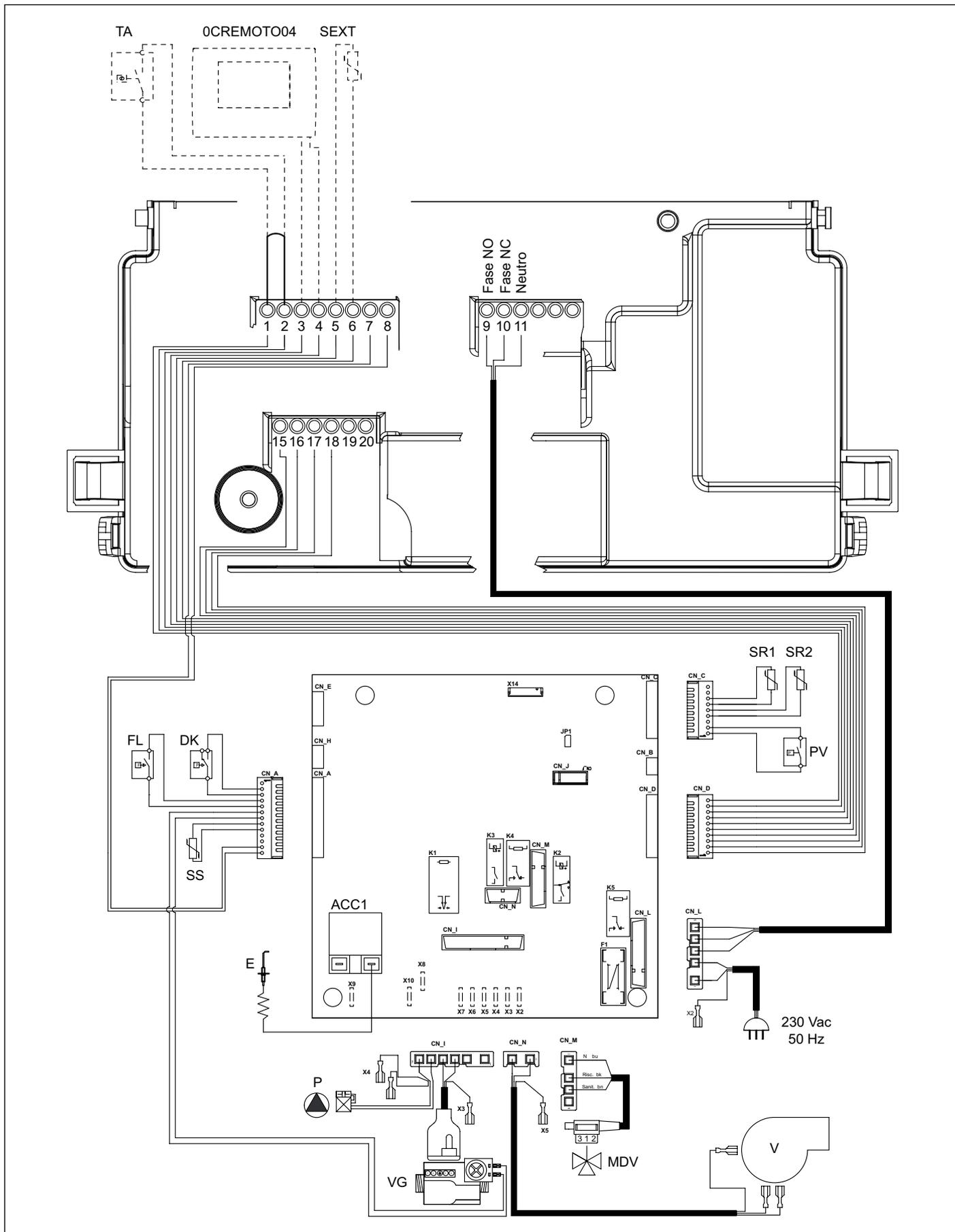
Рис. 24 Электрическая схема CTFS
