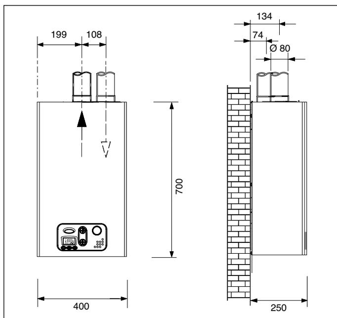
Рис. 17 Размеры для подсоединения отдельных труб воздухоподачи/дымоотвода
