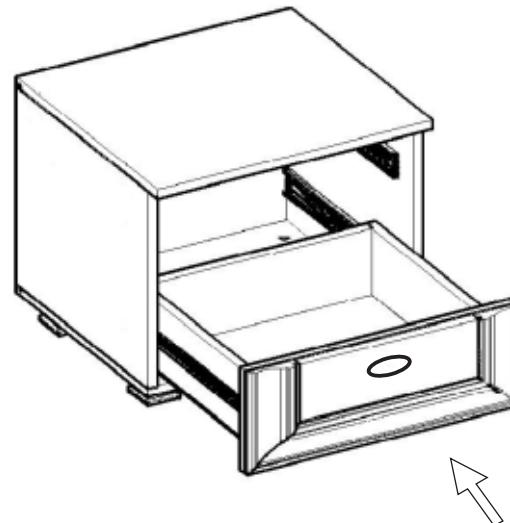
**8** После окончательной сборки установить ящики на направляющие 83. Во всех видимых местах в головку конфирматы 51 установить заглушку конфирмата 52, в эксцентрик 53 установить заглушку эксцентрика 55. В технологические отверстия для сборки изделия на обе стороны на боковинах тумбы установить самоклеющиеся заглушки 56.
