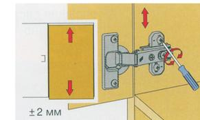
Слегка ослабить крепёжные винты ответной планки, измерить по высоте позицию двери. Затем крепёжные винты снова затянуть.
