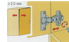
Ослабить крепёжный винт и отрегулировать расстояние между дверью и боковой панелью шкафа.
