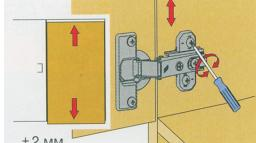
Слегка ослабить крепёжные винты отвентной планки, вымерить по высоте позицию двери. Затем крепёжные винты снова затянуть.
