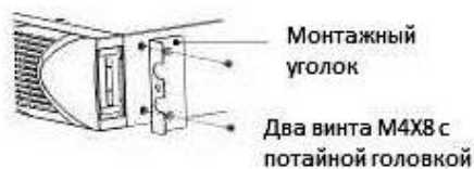
Рис.3 Установка монтажных уголков
