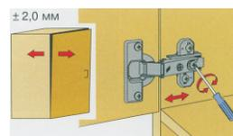
Ослабить крепёжный винт и отрегулировать расстояние между дверью и боковиной шкафа. Затем крепёжные винты снова затянуть.
