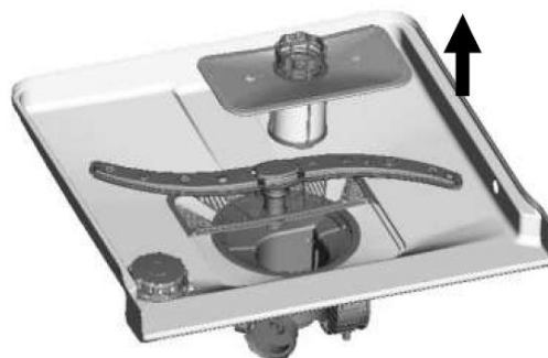
Шаг 2: Выньте фильтр движением вверх
