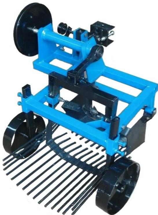
Картофелекопалка предназначена для механизированного выкапывания картофеля, отделения клубней от почвы и укладывания на поверхность для дальнейшего ручного сбора. Также возможно собирание лука, свеклы, чеснока. Модуль состоит из активного ножа и трясущего решета. Возможно регулирование глубины выкапывания при помощи опорных колес, качество сепарации почвы регулируется при помощи оборотов двигателя мототрактора.
