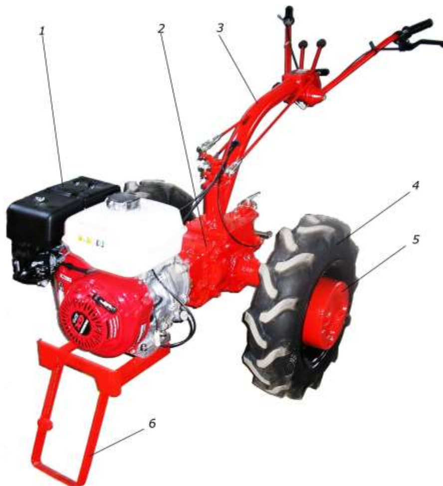
Рисунок 1 – Мотоблок (вид слева) 1 – двигатель; 2 – силовая передача; 3 – рулевая штанга; 4 – колесо; 5 – груз; 6 – подножка
