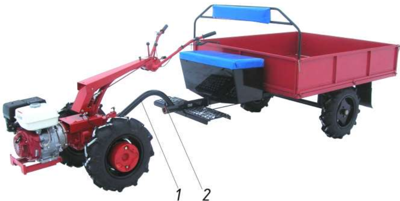
Рисунок 20 – Мотоблок в агрегате с прицепом 1 – дышло; 2 – педаль тормоза
