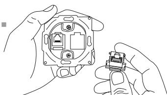
Подсоединить защищенные телефонные провода к клеммной колодке, затянуть винты, подсоединить провода интернет-кабеля используя специальный нож.
