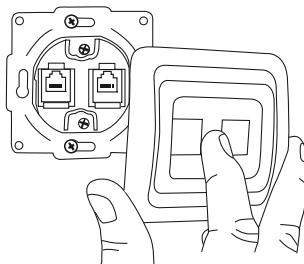
Установить механизм изделия в углубления стены, зафиксировать стопорные и крепежные винты на корпусе изделия, затянув их до упора. Установить декоративную рамку и крышку на место.
