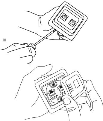
Отсоединить крышку и декоративную рамку от корпуса розетки, поддев наконечником плоской отвертки.
