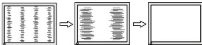
3. После настройки элемента Clock (Синхронизация), если на изображении видно размытие, мерцание или полосы, продолжите регулировку Phase (Фаза).
