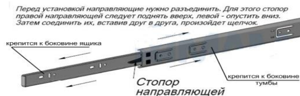
Рис.3 Схема установки шариковых направляющих
