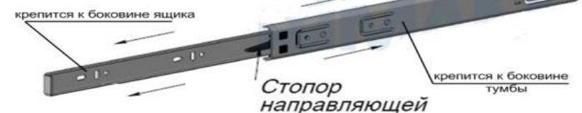
Рис.4 Схема установки шариковых направляющих
