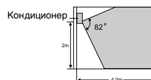
Высота установки кондиционера более 2 м
