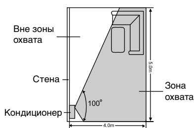
Кондиционер установлен в левой стороне комнаты
