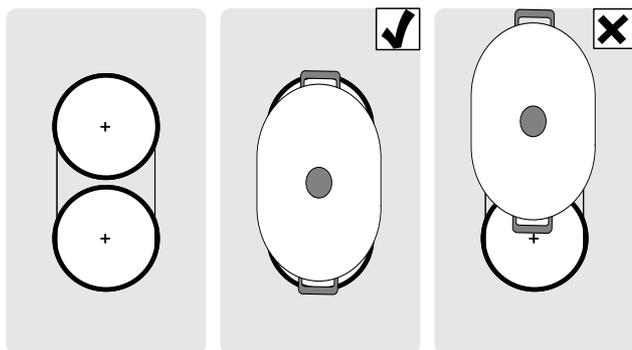
Если вы используете посуду только на одной конфорке, ее можно передвинуть на вторую конфорку. В этом случае ступень нагрева конфорки и выбранные установки будут приняты.
