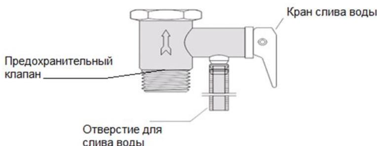
Запобіжний клапан виконує дві функції:
