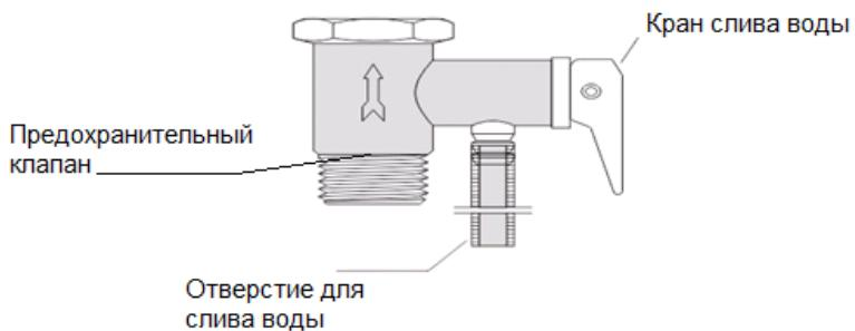
**Внимание! Между входным патрубком водонагревателя и предохранительным клапаном должно обеспечиваться соединение с постоянным полным проходом. Установка запорной арматуры (краны, вентили и т.п.) на этом участке не допускается!**
