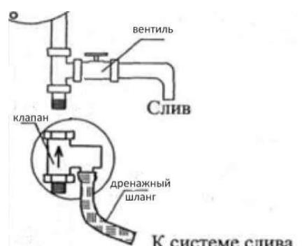
Во избежание поломки при завинчивании предохранительного клапана не применяйте больших усилий.
