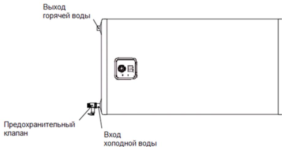
2. При вертикальному варіанті встановлення апарату підведення холодної води здійснюється до **ПРАВОГО** патрубка водонагрівача, і запобіжний клапан встановлюється на цей **ПРАВИЙ** патрубок. У цьому випадку відведення нагрітої води до споживачів здійснюється через **ЛІВИЙ** патрубок (див. малюнок нижче).
