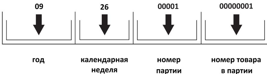
В данном примере прибор изготовлен на 26 неделе 2009 года.
