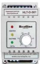
Терморегулятор предназначен для управления системами электрообогрева трубопроводов и резервуаров, системами антиобледенения и системами тёплых полов, а также для управления работой нагревательных приборов, отопительных систем, систем горячего водоснабжения и прочих устройств, требующих контроля температуры. Устанавливается в электрощит на DIN-рейку.
