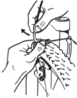
Ободные V-образные тормоза (V-brakes) и их растягивание для снятия колеса
