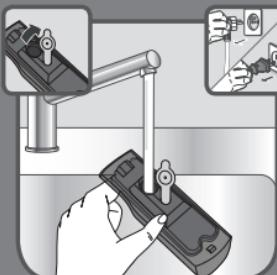
مخزن آب را با 100% آب پر کنید و این عملیات را دوباره تکرار کنید تا زمانی که مخزن آب کاملاً خالی شود و بعد دستگاه را تمیز کنید.
