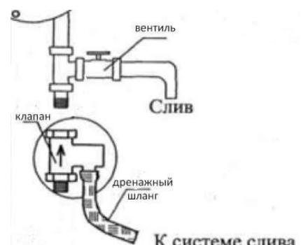
Появление капель воды из отверстия предохранительного клапана во время нагрева воды является естественным процессом и связано с расширением воды в баке при нагревании. Отверстие клапана советуем соединить отводной гибкой трубкой с системой слива. Ни в коем случае нельзя закрывать отверстие клапана!
