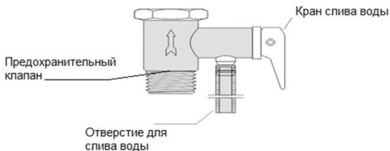
Запобіжний клапан виконує дві функції:
