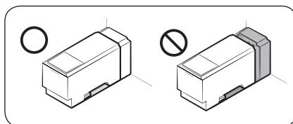
3. Вставьте обратно резервуар и установите его в механизм диспенсера. Убедитесь, что передняя сторона (с передней заслонкой) резервуара направлена в вашу сторону.
