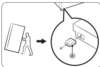
Для предотвращения падения холодильника или его тряски во время работы либо вследствие полной загрузки боковой полки при пустой холодильной камере, установите **подпорку дверцы** (A), следуя приведенным инструкциям. Работу необходимо выполнять вдвоем.
