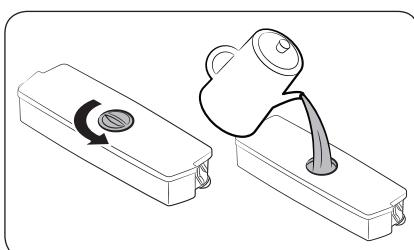
2. Suv bakini 2,3 litrgacha bo'lgan ichimlik suvi bilan to'ldiring. Suvdonning tepe qopqoqchasi yoki butun qopqog'ini chiqarib oling va unga suv qo'ying.
