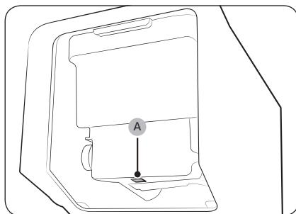
Если автоматический льдогенератор не производит лед, снимите ведёрко и нажмите кнопку Проверка (A), чтобы проверить правильность его работы.
