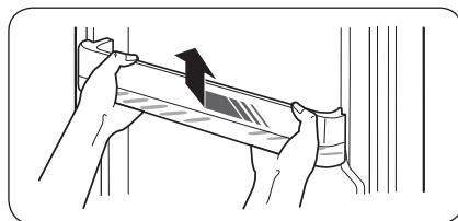
Слегка приподнимите и извлеките дверной лоток.
