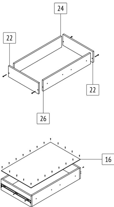
Разметка на вертикальных стенках ящиков отсутствует. Устанавливать ответную часть направляющей следует строго по центру.
