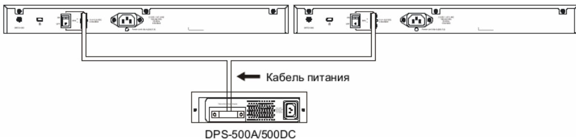
Рисунок 10 — Подключение двух коммутаторов к DPS-500A/500DC
