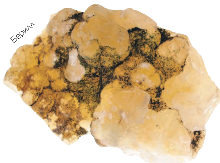
Минерал берилл представляет собой алюмосиликат бериллия \text{Al}_2[\text{Be}_3(\text{Si}_6\text{O}_{18})] , то есть соединение бериллия с алюминием, кремнием и кислородом.
