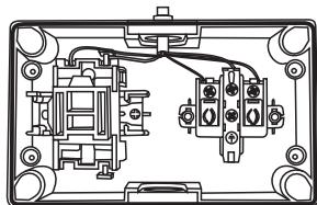
Установить механизмы изделий и сальник в корпусе изделия, установить лицевую панель, затянуть винты.
