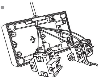
Продеть кабель через верхний или нижний сальник. Подсоединить провода, просунув защищенные концы в пазы контактных зажимов.
