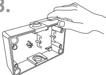
Аккуратно срезать верх герметизирующего сальника в соответствии с диаметром подсоединяемого кабеля.
