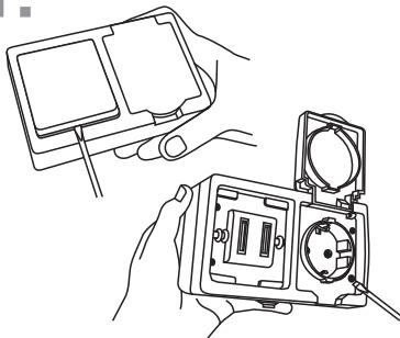
Снять клавишу, путем ее поднятия наконечником плоской отвертки.
