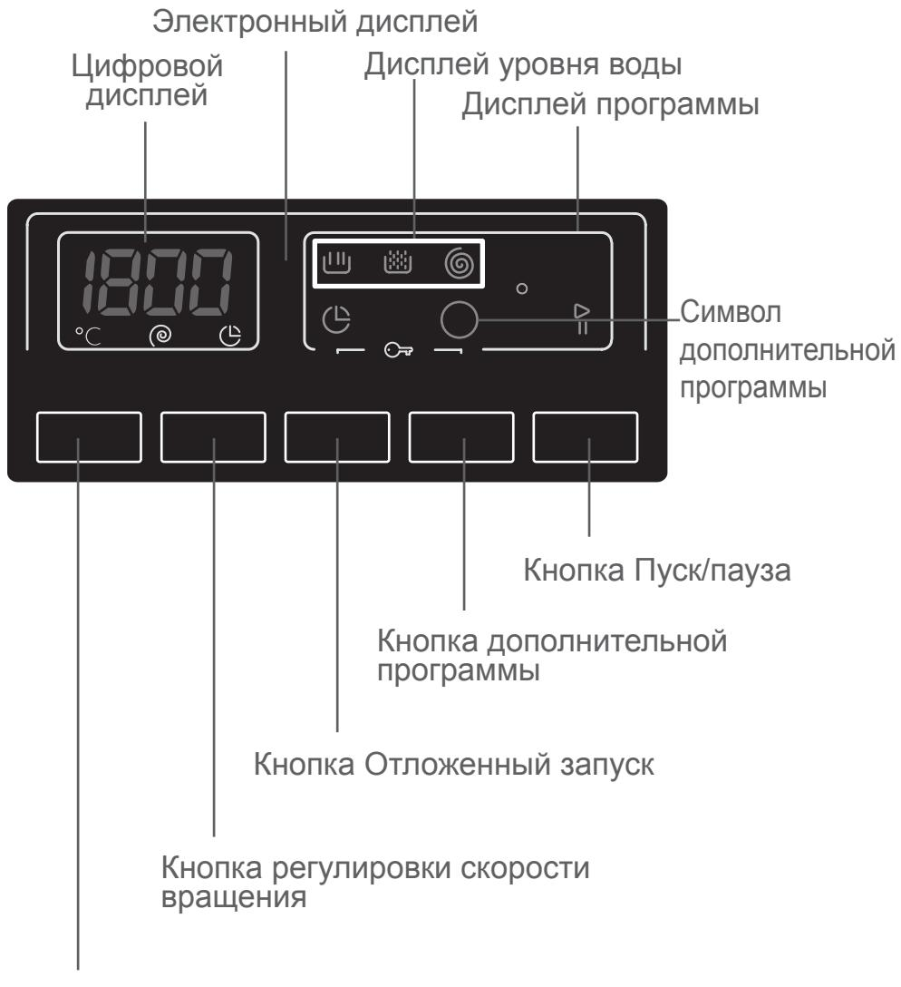
Кнопка регулировки температуры воды
