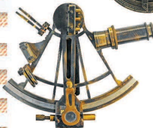
Секстант — астрономический прибор для измерения высоты космических объектов над горизонтом.
