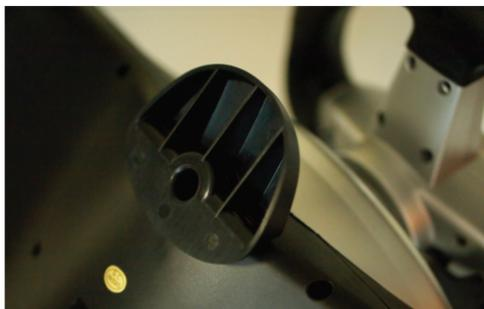
При желании вы можете зафиксировать руль на краю столешницы при помощи струбины из комплекта поставки. Вкрутите винт струбины в отверстие на нижней поверхности игрового манипулятора как показано на изображении, предварительно вынув из него подставку. Не прилагайте чрезмерного усилия при закручивании винта.
