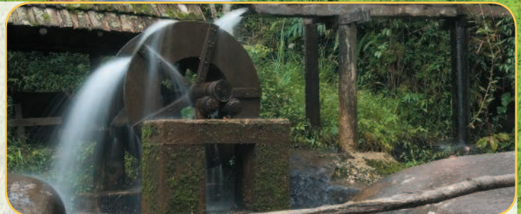
Водяное колесо с верхней подачей воды.
