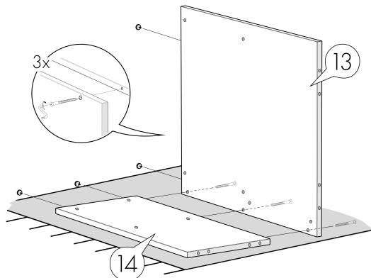
**2** К опорам (детали №13, №14) прикрутите полки (детали №15, №16) через соответствующие отверстия. Деталь № 16 располагается ниже детали № 15.
