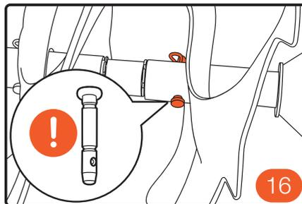
**Примечание:** Шнек крепится на валу при помощи штифтов безопасности (рис. 16). Они разрушаются при попадании в шнеки твердых предметов или при перегрузке. Используйте только оригинальные штифты.
