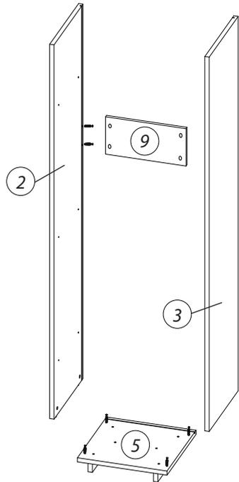
После соединения эксцентрики закрутить по часовой стрелке до упора.
