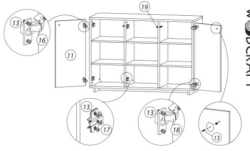
Установите на перегородки толкатели дверей. Установите на двери площадку толкателя. У площадки толкателя пластина должна быть направлена к ближайшей кромке.
