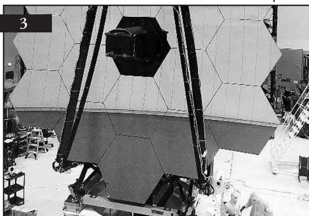
3. Сборка телескопа «Джеймс Уэбб» в лаборатории Центра космических полетов Годдарда НАСА. В лаборатории поддерживается стерильная чистота.
