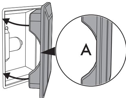
7. Нажмите на крышку таким образом, чтобы она плотно прилегалась к патрону лампочки.
