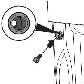
Закройте втулки ранее снятыми заглушками.
