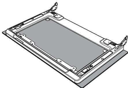
7. Прорезиненные планки **A**, **B** и **C** промежуточного стекла должны быть повернуты в направлении наружного стекла.
