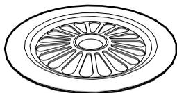
Служит для равномерного распределения пара внутри рабочей камеры.
