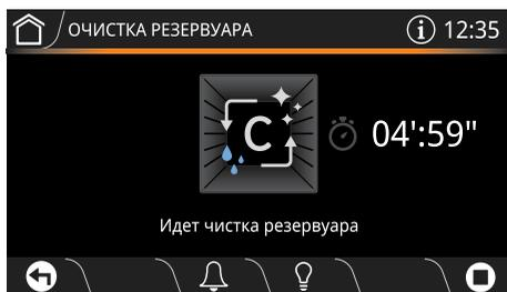
По окончании чистки сработает звуковая сигнализация и на дисплее отобразится окно удаления смеси.
