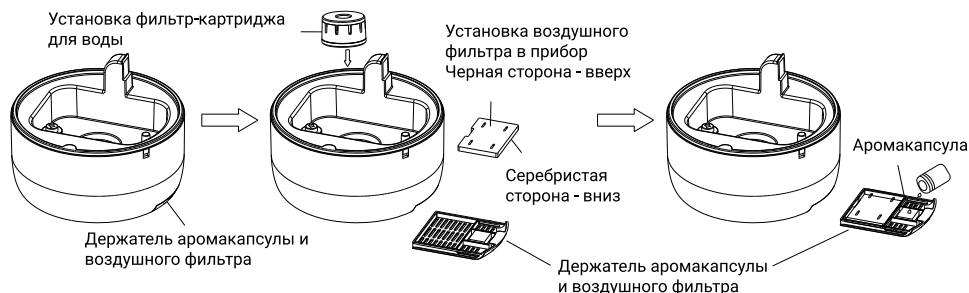
Рис.4 Установка фильтр-картриджа и фильтра предварительной очистки, использование аромакапсулы
