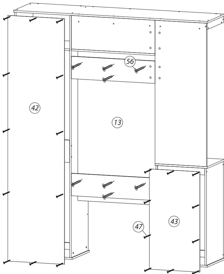
Щит с каретной стяжкой(13) установить при помощи саморезов(56), заднии стенки ДВП(42, 43) прибить гвоздями(47).
