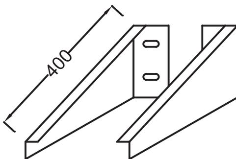
Спецификация продукта: Кронштейны для столешницы. EB509. Коллекция: PARALLEL. РАЗМЕРЫ (CM): 40 x 8 x 10 см. ВЕС: 2,2 кг. АКСЕССУАРЫ ДЛЯ МЕБЕЛИ: Кронштейны. Оцинкованный металл.
