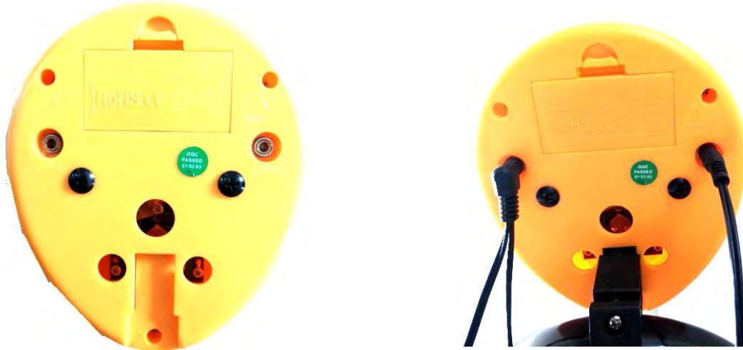
Подключите “7” glyph сзади компьютера в разъем со словом “Pulse”, “1” glyph - “Speed”.
