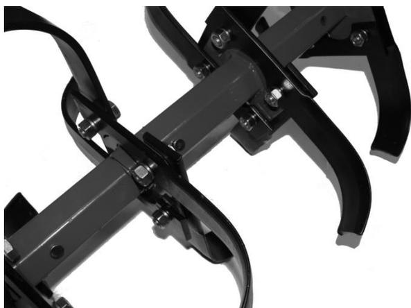
В дальнейшем, после прибытия на место культивирования пригласите помощника, демонтируйте ведущие колеса и установите фрезы на выходной вал редуктора, используя тот же крепеж, которым крепились колеса.
