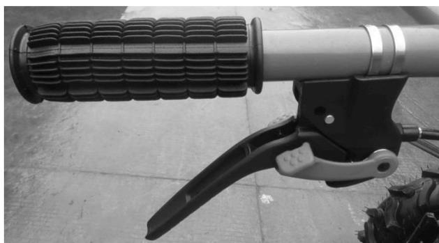
Ручка включения заднего хода расположена на правой рукоятке. Ее самопроизвольное нажатие блокирует специальный фиксатор, не нажав на который у Вас не получится зажать ручку включения задней передачи. Прежде, чем включить заднюю передачу необходимо:
