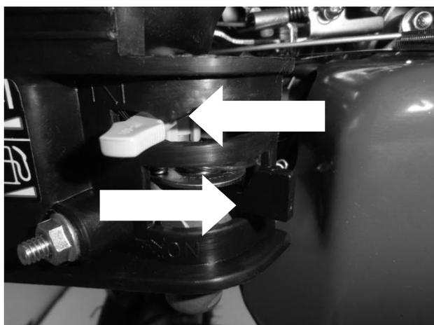
1. Установите рычажки на панели управления карбюратором как показано на рисунке.
