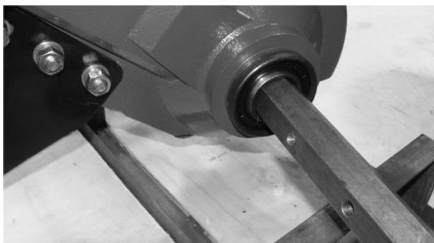
Спозиционируйте выходной вал посередине редуктора .
