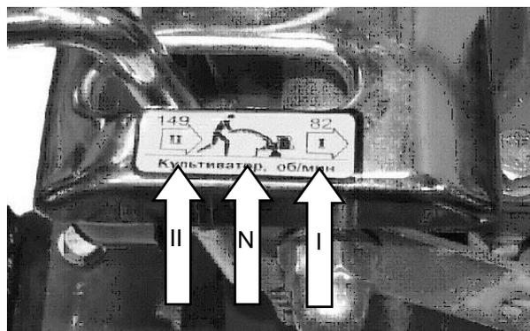
4. Переведите рычаг переключения в нейтральное положение. Это среднее положение между первой и второй передачами (стрелка N на рисунке). Если Вы впервые сталкиваетесь с подобной системой переключения - опробуйте все режимы. Включение передачи сопровождается характерным «защелкиванием» рычага в передачу. Переключение между движением вперед и назад также должно происходить с выжимом сцепления.
