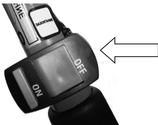
2. Выключатель зажигания находится на левой рукоятке, над ручкой управления сцеплением. Нажатием на соответствующий выступ переведите его в положение «OFF» - выключено.
