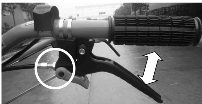
Выберите люфты в тросиках сцепления и газа. Для этого используйте резьбовые втулки с контргайками на концах тросов (для троса газа может быть в середине). Выжим сцепления должен быть четкий, Вы должны чувствовать, что преодолеваете сопротивление пружины механизма сцепления.
