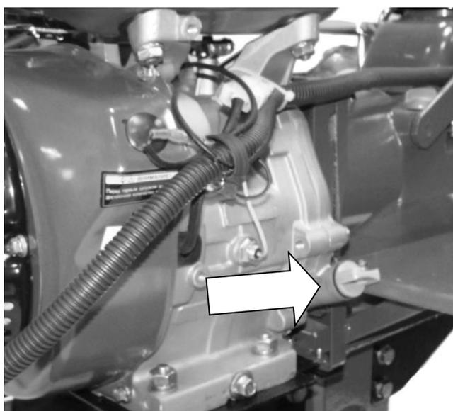
Укладка проводки. Аккуратно уложите проводку, используя стяжки из комплекта и крепежи на корпусе изделия.
