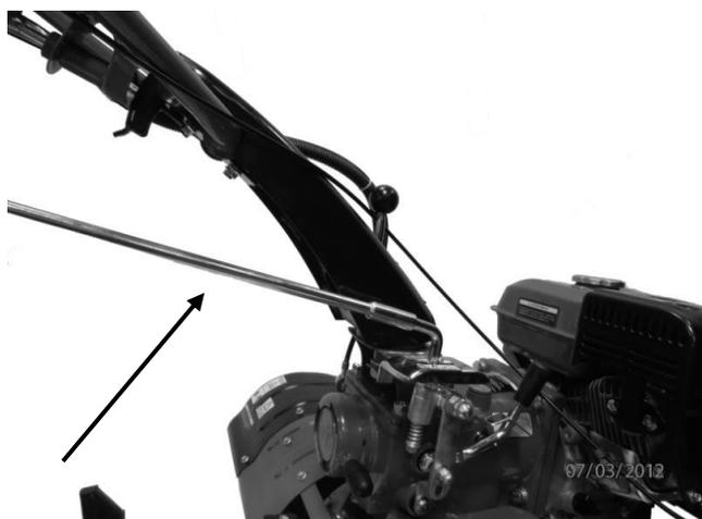
Монтаж удлинителя рычага переключения передач.
