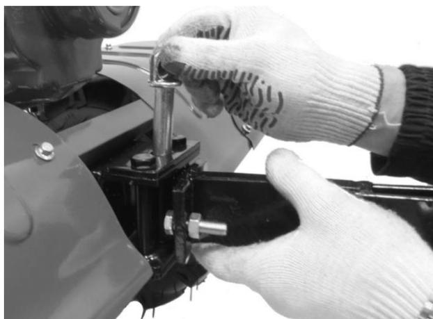
Монтаж кронштейна сошника и сошника. По прибытии на место культивирования отрегулируйте заглубление сошника в зависимости от плотности почв. При работе с мягкими почвами устанавливайте сошник в крайнее нижнее положение, при работе с твердыми почвами в крайнее верхнее. Проводить культивирование без установленного сошника **ЗАПРЕЩЕНО!!!**
