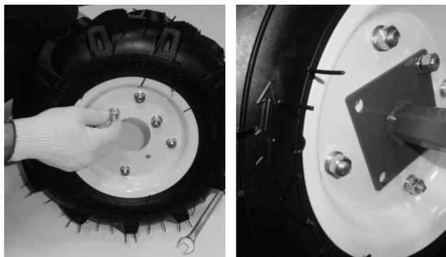
Начните сборку с колес. Выкрутите из каждого колеса по четыре ближних к центру болта. Возьмите валы и прикрутите их к колесам, используя ключ на и выкрученные ранее болты. Обратите внимание, что колеса имеют направленный протектор.
