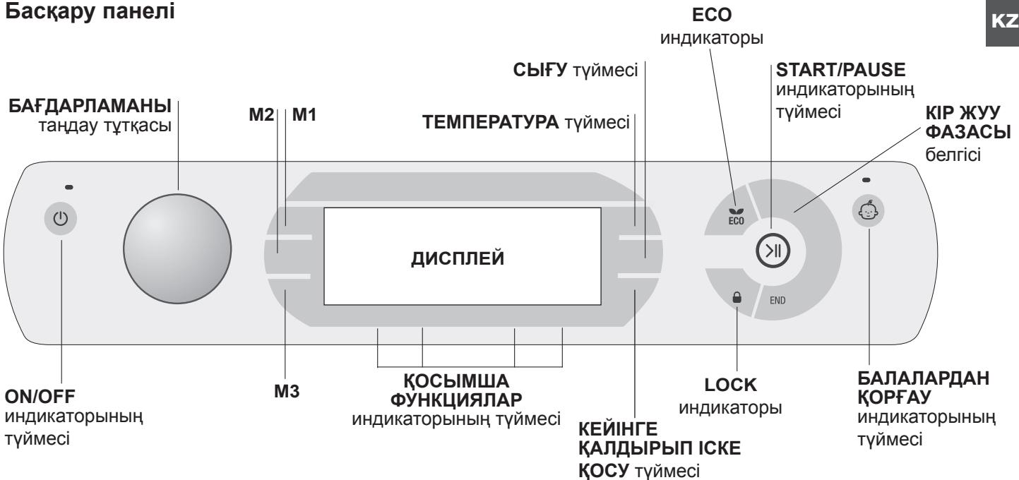
① **ON/OFF** индикаторының түймесі: қосу және өшіру үшін түймені бір рет басыңыз. Жасыл индикатор машинаның қосылып тұрғанын білдіреді. Кір жуғыш машинаны қосу үшін кір жуу процесінде түймені шамамен 3 секунд басып ұстап тұру қажет. Қысқа немесе кездейсоқ басып қалғаннан машина өшіп қалмайды. Машинаны өшірген жағдайда кір жуу процесінде ағымдағы цикл жойылады.
