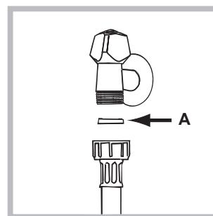
2. Вставьте прокладку А в конец водопроводного шланга и привинтите его к водопроводному крану холодной воды с резьбовым отверстием 3/4 дюйма (см. схему). Перед подсоединением откройте водопроводный кран до тех пор, пока из него не потечет чистая вода.
