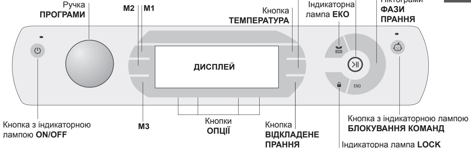
**Кнопка з індикаторною лампою ⚡ ON/OFF:** швидко натисніть і відпустіть кнопку для вимикання або вимикання машини. Зелена індикаторна лампа означає, що машина ввімкнена. Для вимикання пральної машини під час прання необхідно утримувати кнопку натиснутою приблизно більш ніж 3 сек.; короткочасне або випадкове натискання не дозволить вимкнути машину. Вимикання машини під час циклу прання відмінює це прання.
