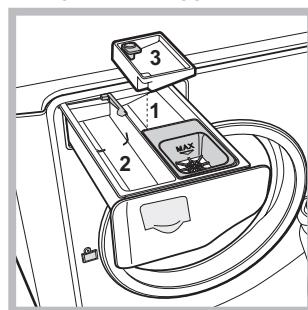
Циклдің басында көп мәлшерде кірді және ұзақ уақыт пайдалану арқылы функция оңтайлы кір жууды қамтамасыз етеді. Бұл функция қыын дақтарды көтіру үшін қажет. Қосымша 3-мәлшерлеуішті 1-мәлшерлеуішке қойыныз. Ағартқыш қойылғанда стерженнің ортасында көрсетілген
