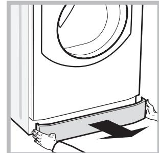
1. снимите переднюю панель стиральной машины, нажав в центре, затем потяните ее вниз за края и снимите ее (см. схемы);
