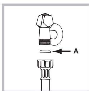
2. Вставте прокладку А у кінець шлангу для подачі води та вкрутіть його у кран з холодною водою з різьбою 3/4 (див. малюнок).
