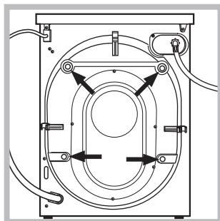
2. Тасымалдау кезінде машинаны қорғаушы 4 винтті және кір жуғыш машинаның артқы жағындағы резенке тығындарды сәйкес тірекіш шайбамен ашыңыз (сур. қара).
