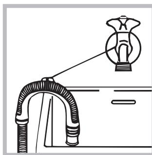
Су төгу шлангісі орналастырылуы суды төккен кезде судың бөліп-бөліп төгілгөн қамтамасыз етуі керек (шлангінің аяқ жағы суға тимеуі тиіс). Ваннаның немесе раковинаның шетінен қатырған жағдайда, шлангінің кранға қатырылатын бөліктің
