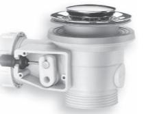
IT La guaina di trasmissione realizzata in PA66 (materiale nylon ad alte prestazioni) con terminali co-stampati è fissata al corpo del troppo pieno e del sottopiletta con un sistema a pressione senza l'ausilio di blocaggi meccanici che potrebbero determinare imprecisioni nel tempo e risulta perfettamente inamovibile.
