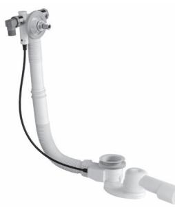
IT Scarico per vasca mod. A4 con sifone snodato uscita Ø 40/50 mm. Cavo cm 47,5
