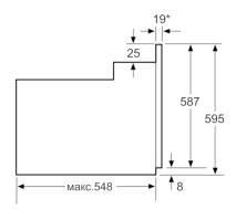
\* При металлической фронтальной панели 20 мм
